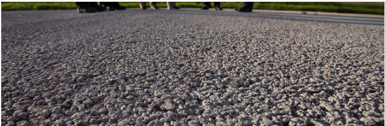
ThruCrete, inovasi beton berpori yang memudahkan penyerapan air ke dalam tanah. Porous concrete innovation that can absorb water rapidly into the ground.
